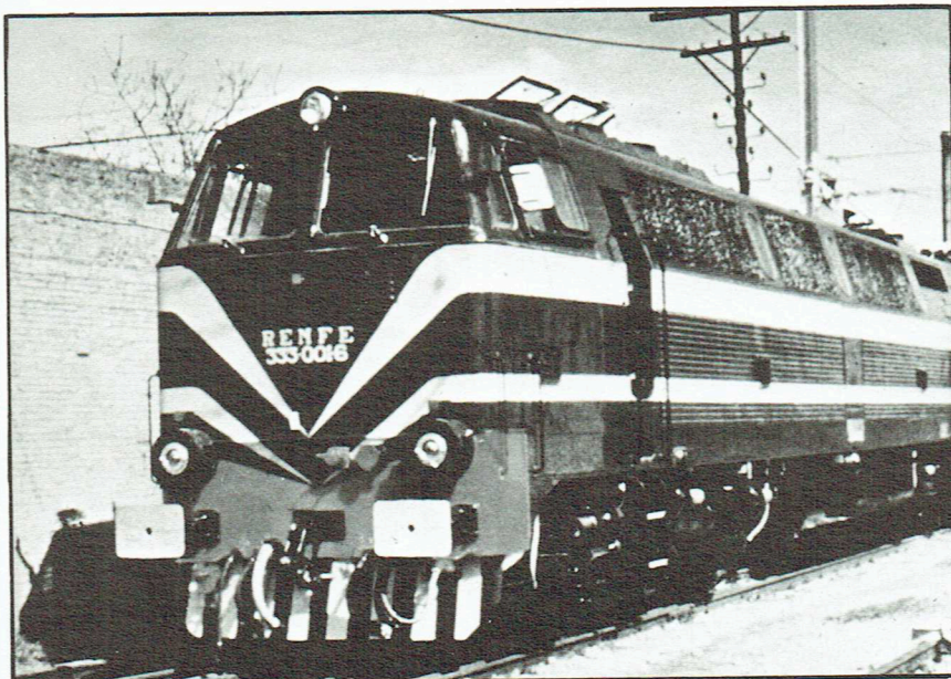
Figura 1: Locomotora diesel-eléctrica serie 333 de RENFE
